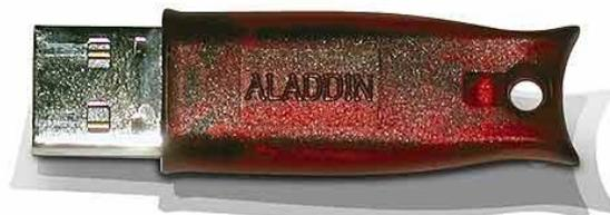
отсутствуют дорогостоящие аппаратные считыватели. Идентификатор, называемый USB-ключом, подключается к USB-порту компьютера непосредственно или с помощью соединительного кабеля.
